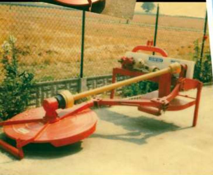
Mediante un sistema autolivellante, non necessitano di un continuo adattamento al terreno e raggiungono un'inclinazione di oltre 70° per un'accurata pulizia di fossi e cunette.
