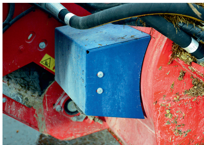
På bagsiden af fræserhovedet sidder NIR-sensoren fra FoderTeknik godt beskyttet.
