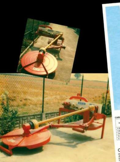
Mediante un sistema autolivellante. non recessitano di un continuo non recessitate di un continuo adattamiento ai serreno e raggiangore un inclinazione di citre 70° per un'accupata pulizia di tossi e curette.
