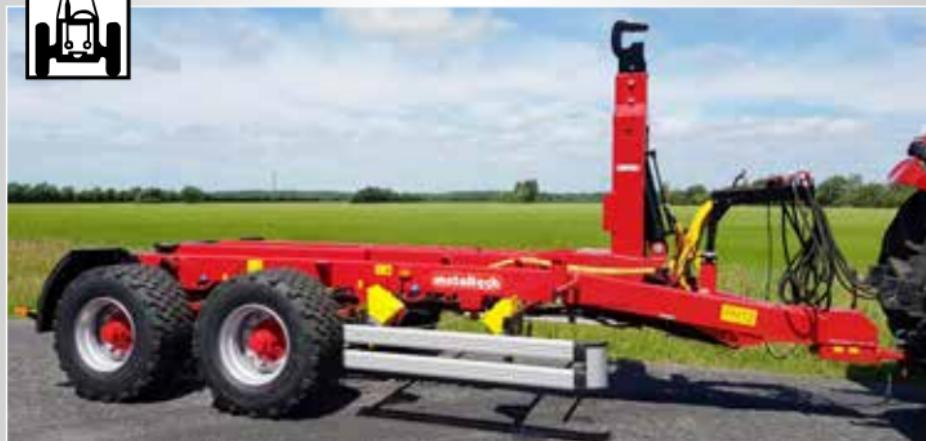
HOLSO-Kroghejsevognen er en containervogn, der hurtigt og nemt henter og bringer containere til det ønskede sted. Vognen kan håndtere containerkasser, der anvendes indenfor vognmandsbranchen. Vognen produceres på den polske fabrik Metaltech. Den har samme kraftige undervogn som entreprenørvognen. RADIAL-dæk anbefales til vejkørsel.
